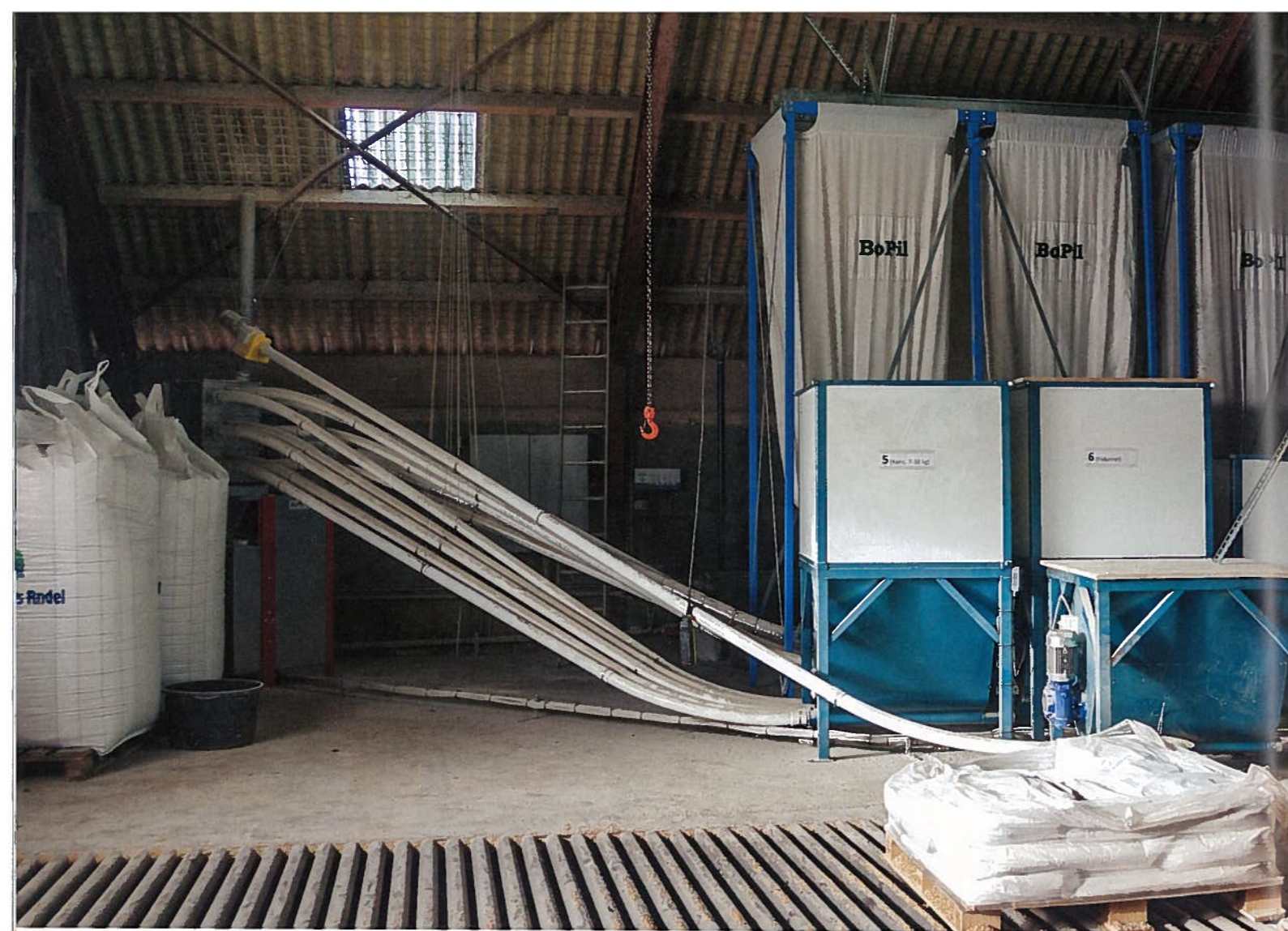
■ Hele hjertet af spotmix anlægget. Her i klimastalden. Bemærk stofsiloerne, som ifølge Jan Bonde giver et nemmere overblik over hvad der er tilbage i en silo, og som aldrig har problemer med at indholdet danner bro.
